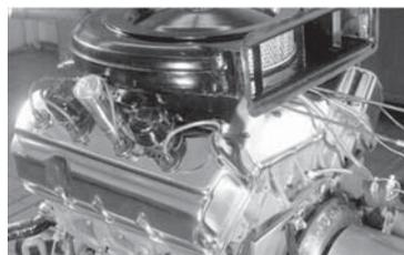
Um dos protótipos do 426 Hemi na primeira rodagem no dinamômetro.
